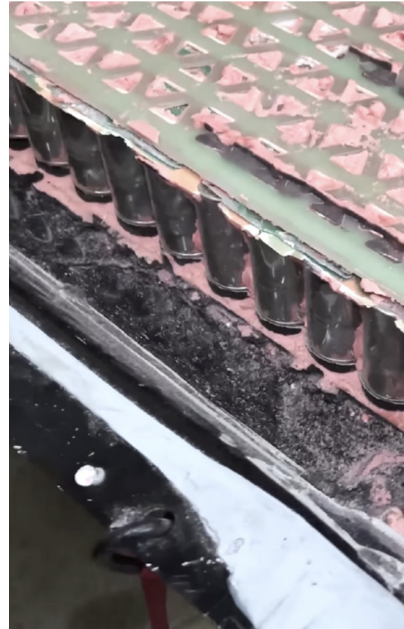
Mousse rose empêchant l'accès aux modules. Source : Extrait de la vidéo «4680 Battery Pack: What We Found Under the Foam !», Chaîne YouTube Munro Live + numéro 145
